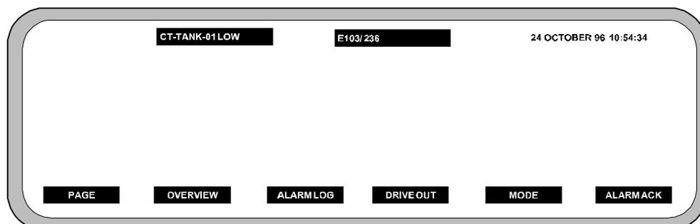
Figura 4-1. Tasti funzione del Datapanel Modello 240E
