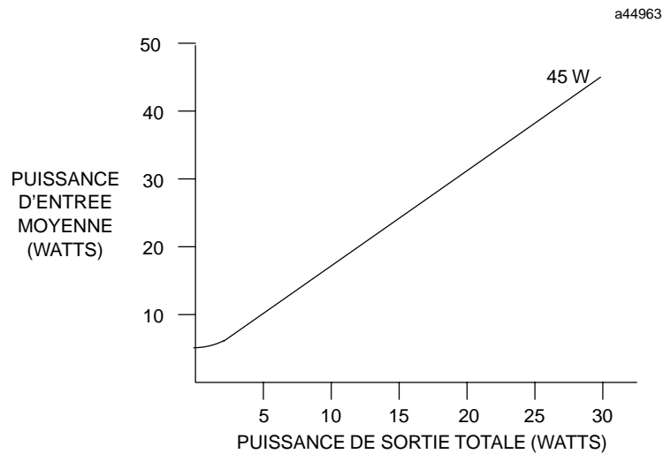
Figure 1-22. Courbe d'efficacité typique pour l'alimentation 24/48 Vcc
