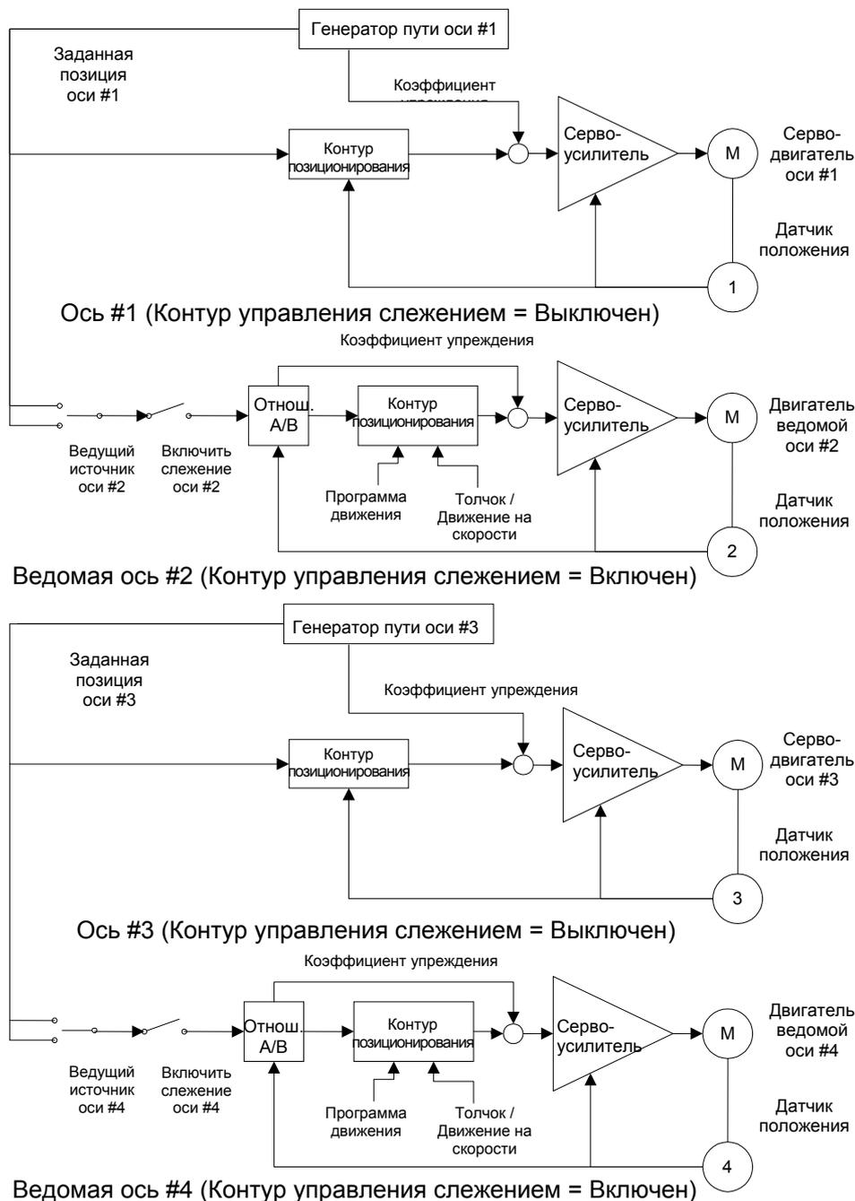
Рис. 8-14. 4-осное Аналоговое следящее устройство / Параллельная структура / Источник = Заданная позиция 1 и Заданная позиция 3
