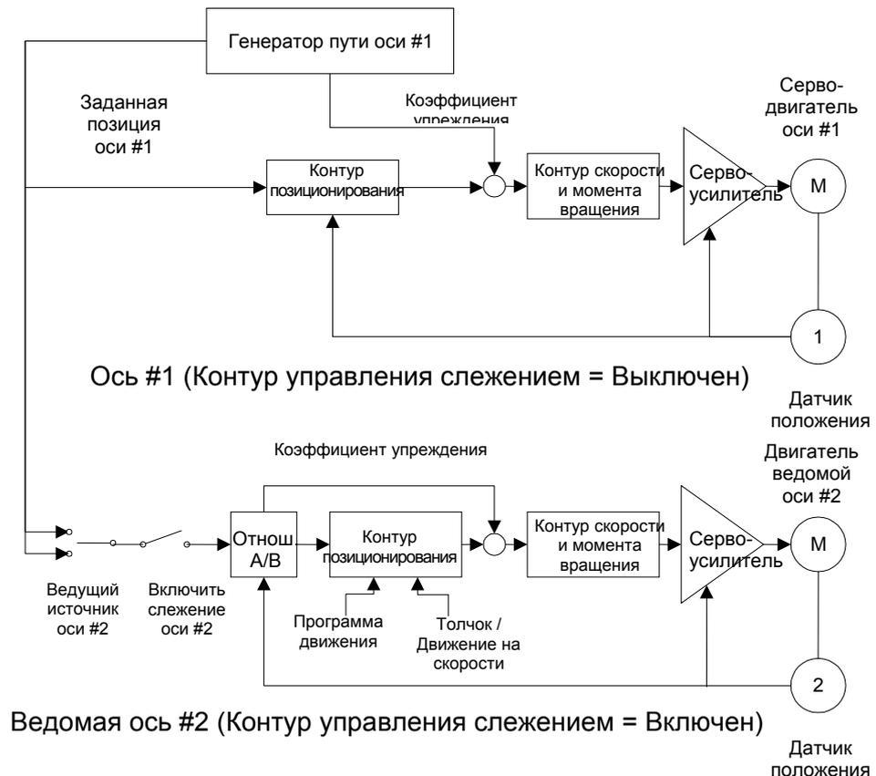
Рис. 8-13. 2-осное Аналоговое следящее устройство / Параллельная структура / Источник = Заданная позиция 1
