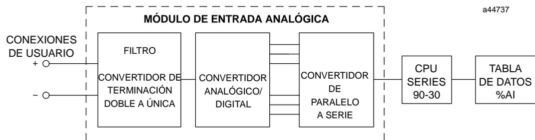
**Figura 9-2. Diagrama de bloques de entrada analógica**
