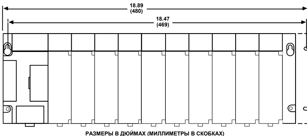
Рисунок 3-19. Размеры для монтажа в 19-дюймовую стойку при помощи кронштейна переходника IC693ACC308
