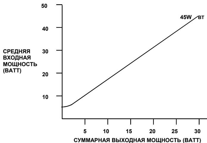
Рисунок 4-5. Типичная характеристическая кривая эффективности модуля питания с 24/48 В постоянного тока на входе
