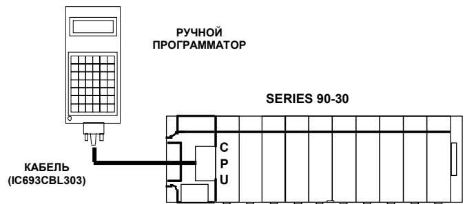
Рисунок 10-24. Соединение ручного программатора и ПЛК Series 90-30
