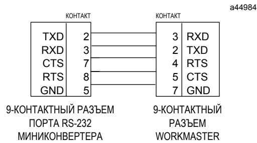
Рисунок D-4. Подключение миниконвертера к 9-штыревому разъему Workmaster или компьютера PC-XT
