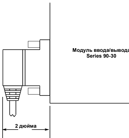
Рисунок 10-41. Размер глубины соединительного разъема
